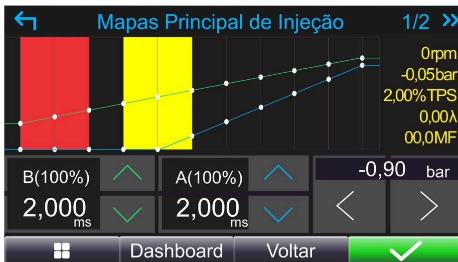
Figura 28 – Mapa Principal de Injeção 2D ( MAP x Tempo de injeção )
