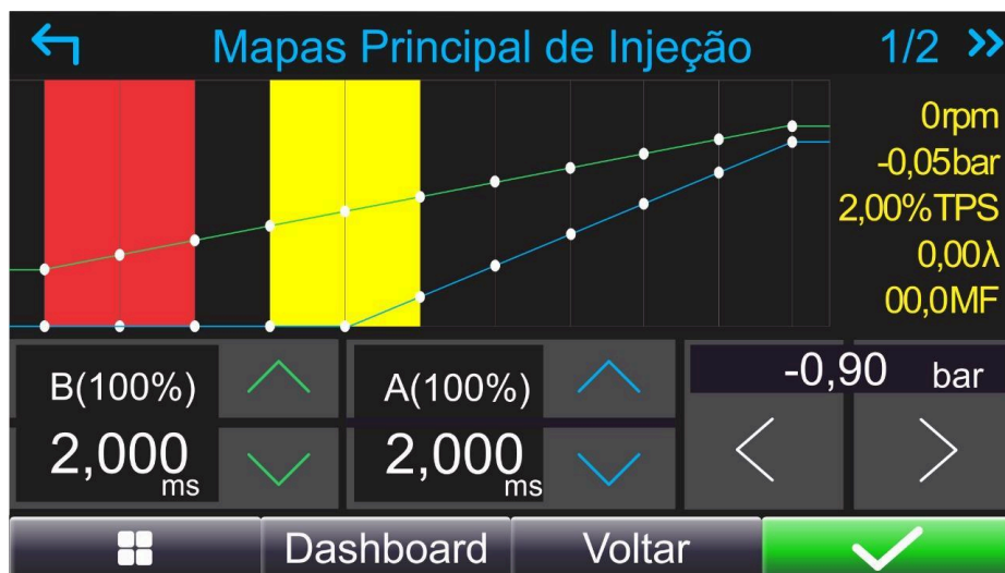
Figura 32 – Mapa Principal de Injeção 2D ( MAP x Tempo de injeção )
